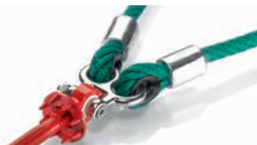
2-Augen-Schäkel aus Edelstahl inkl. Querbolzen M10 Art.-Nr. 440-10 ohne Lager, ideal für Eckausbildung bei Horizontalnetzen, für Herkulesseil Ø 16 mm oder Ø 18 mm, auch als 3-Augen-Schäkel lieferbar, inkl. Querbolzen M8
