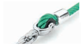
Kauschen-Kettenwirbel aus Edelstahl Art.-Nr. 4603-20 Drehverbindung mit verschleißfester Lagerbuchse aus Bronze für maximale Drehbelastung von Kette 6 mm oder 8 mm an Herkulesseil Ø 16 mm
