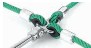
3-Augen-Schäkel aus Edelstahl inkl. Querbolzen M10 Art.-Nr. 440-20 ideal für Eckausbildung bei Horizontalnetzen, für Herkulesseil Ø 16 mm oder Ø 18 mm an Kette 6 mm, 8 mm oder VA-Lager-Adapter, inkl. Querbolzen M8
