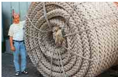
Komplette Seiltrosse, Gesamtgewicht ca. 2 t, Seildurchmesser 16 cm
