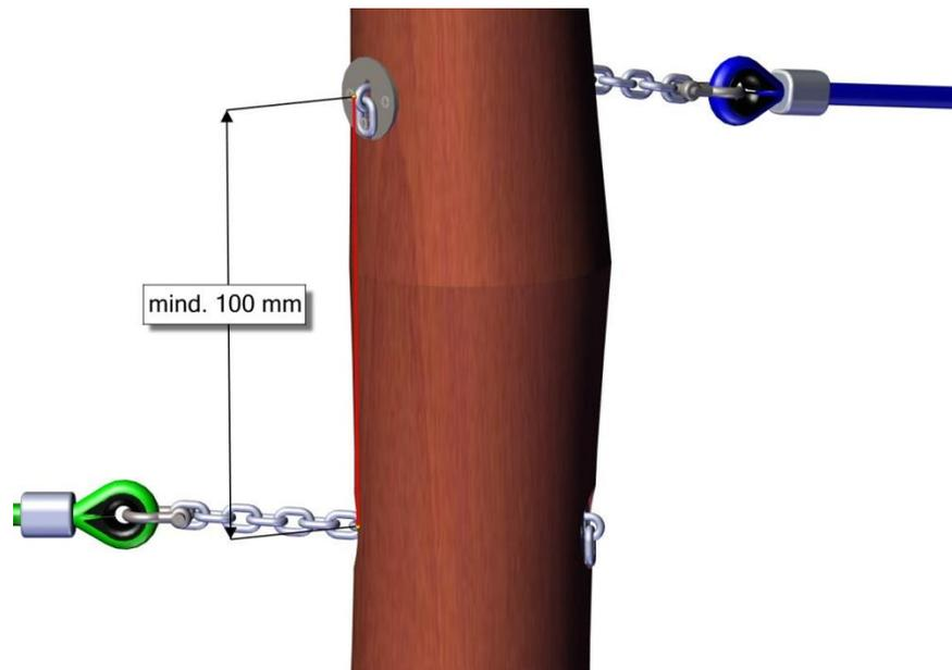
**Beim Aufbau muss der Winkel so eingehalten werden, dass die Bohrungen die Stahllaschen nicht schneiden.**
