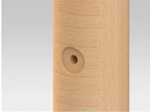
Zuerst den Pfosten mit einer Bohrung  $\varnothing$  22 mm durch bohren. Danach eine Senkung (um die Durchgangsbohrung herum) mit  $\varnothing$  60 mm mindestens 10 mm tief senken. Auch die gegenüberliegende Seite wird genauso gesenkt .
