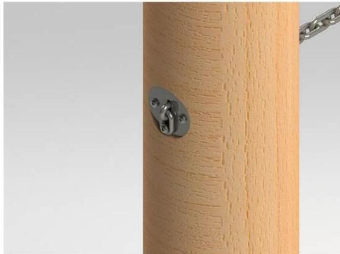
Kette durch den Pfosten führen, spannen und mit beiliegender Schlitzscheibe am Pfosten mit 5,5 x 19 mm Linsenkopfschrauben fixieren. Überschüssige Kette abschneiden und mit Linsenkopfschraube 5,5 x 42 mm befestigen.
